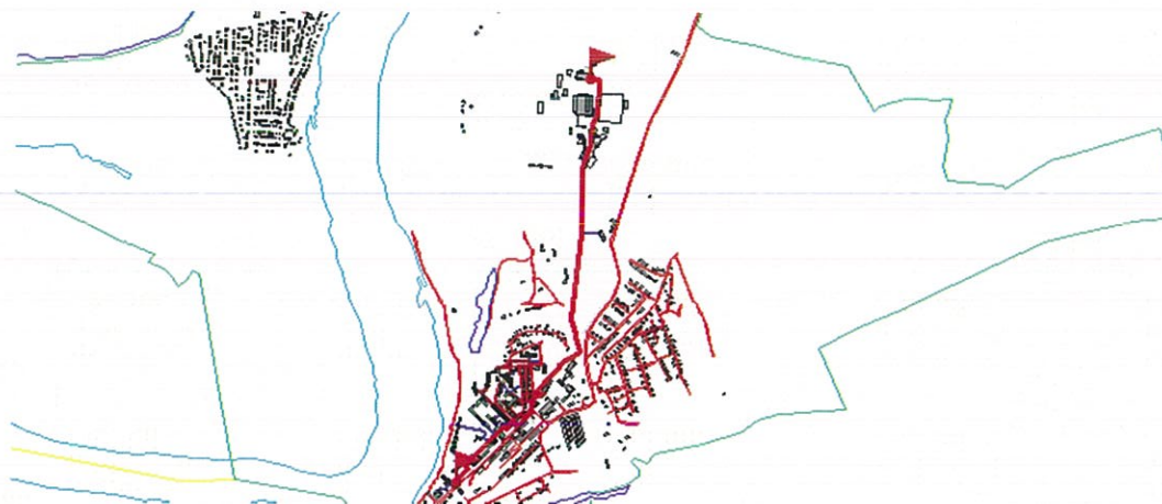
Рисунок 1.25.1. Трассировка магистрального теплопровода «Притомская – Дорстроевская,9»
