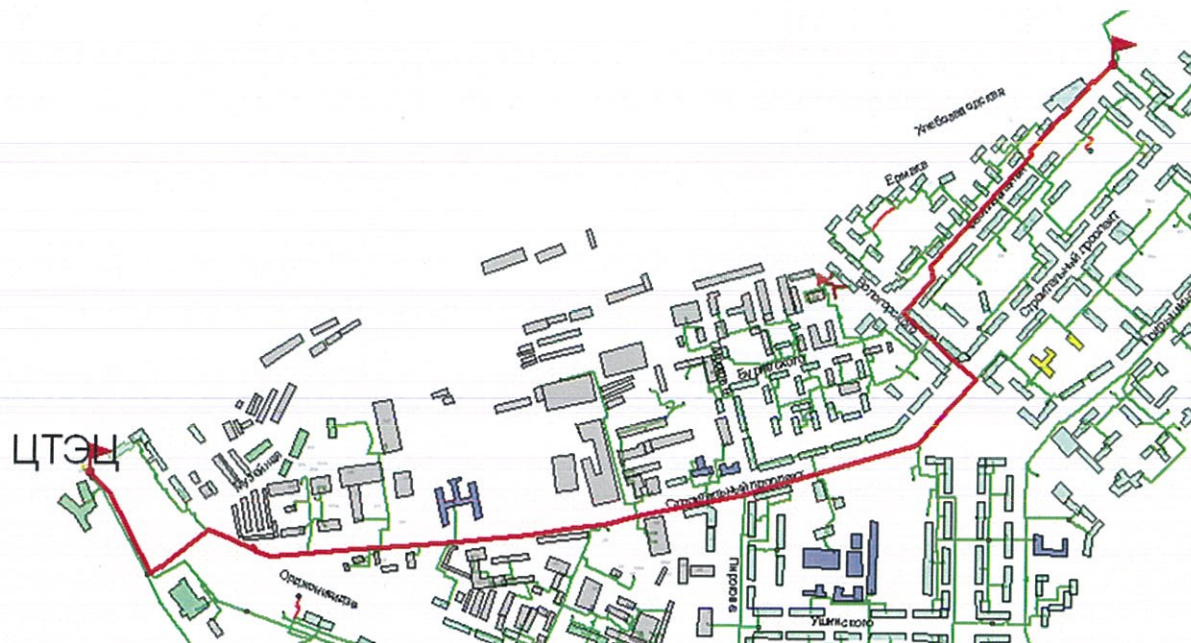
Рисунок 1.18.1. Трассировка магистрального теплопровода «ЦТЭЦ - ТК8 (ул.Фестивальная)»
